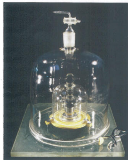
Međunarodna pramjera kilograma (K) jedini je preostali artefakt koji se upotrebljava za definiranje neke osnovne jedinice SI-a.
